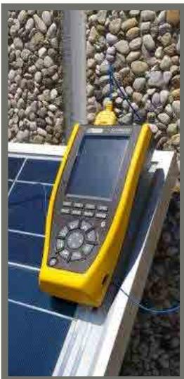
Temperaturmessung an Solarmodulen. Mit der praktischen Multifix-Magnethalterung als Zubehör hat man die Hände frei zum Arbeiten.
